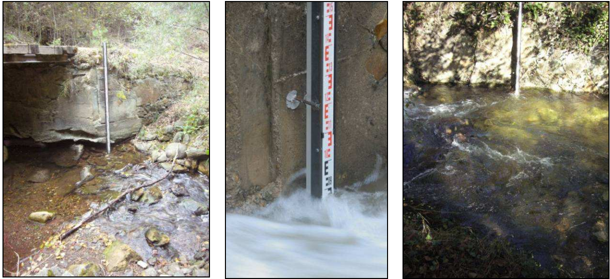
Figure 9 : Photographies des échelles des stations des Peupliers et de Betllans pour différents débits de la Ribera de Nohèdes.
