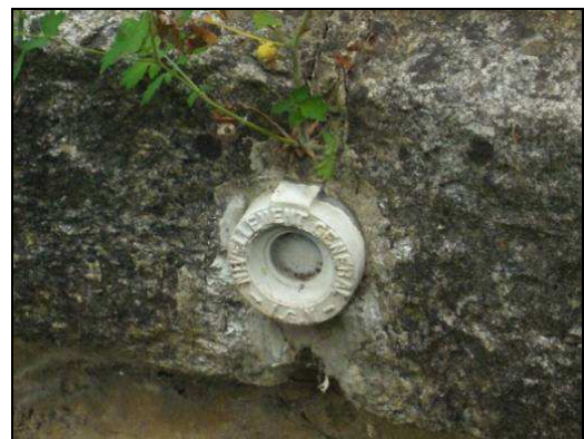
N°28 : Repère de nivellement général (IGN)
