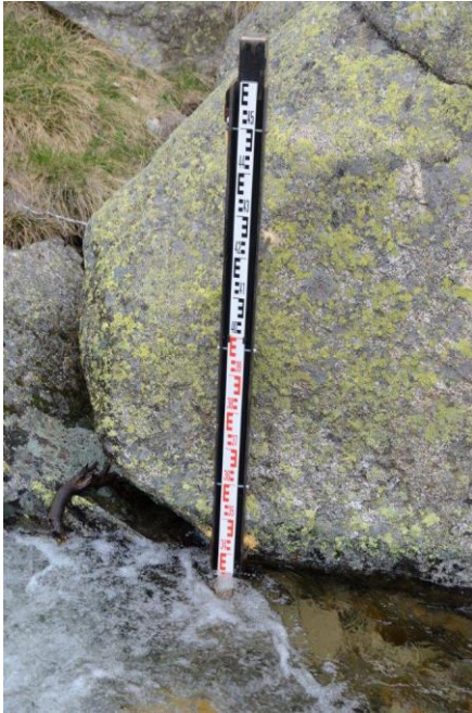
Figure 5 : Photos d'une échelle limnimétrique et d'une sonde OTT Orpheus Mini
