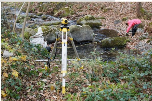
Description des profils en travers (Photo A. M.)
