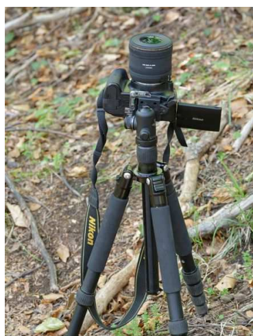
Un système simple pour mesurer la luminosité de la station
