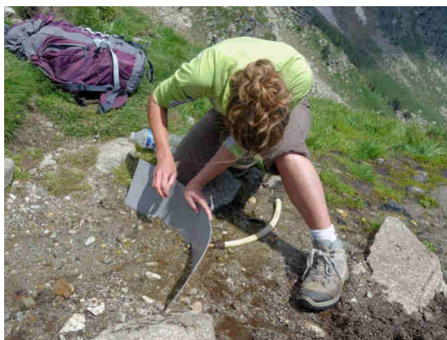
Mesure de débit à la Font de la Perdu (Photo A. M.)
